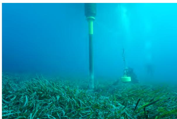
Figure 18 : Vue du carottier Kullenberg dans l'herbier à *Posidonia oceanica*
