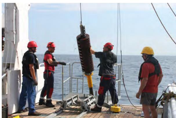
Figure 17 : Mise en œuvre du carottier Kullenberg sur le pont du N/O l'Europe.
