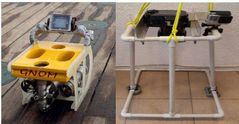
Figure 3 : Équipements utilisés pour l'acquisition des données terrains. A gauche ROV Super Gnom®, équipé de la caméra GoPro - Hero 4 Silver ®; à droite quadrat-photo équipé de l'appareil Sony  $\alpha$ 6000® et de la GoPro.
