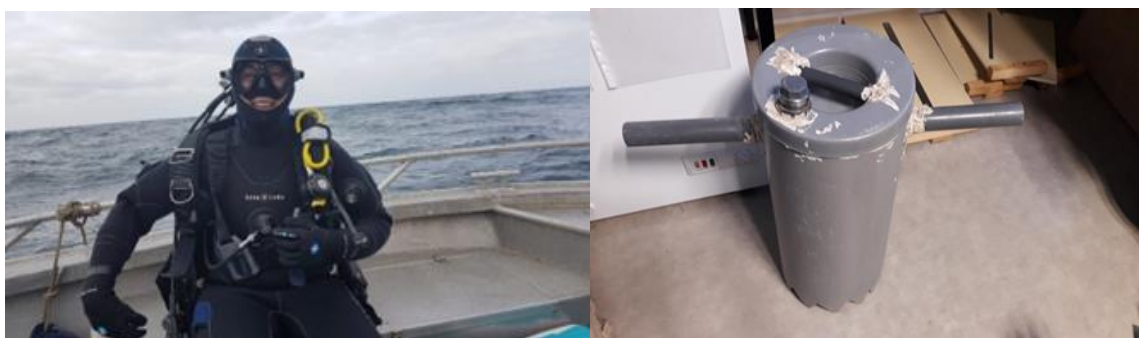
Figure 18 : Plongeur et carottier pour réaliser des prélèvements de sédiments meubles (TBM environnement, 2022).
