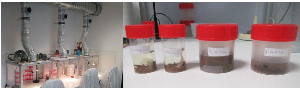
Figure 20 : Postes de tri des échantillons de macrofaune benthique (à gauche) et piluliers de conditionnement (à droite) (TBM environnement).
