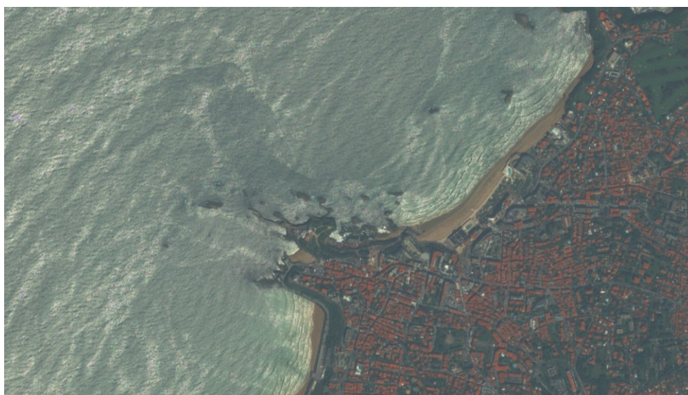
Figure 5 - Exemple d'image Pléiades du 11 juillet 2024 présentant des artefacts de scintillement – glint – sur le plan d'eau limitant la capacité de l'algorithme à détecter automatiquement les navires. La grande plage de Biarritz.
